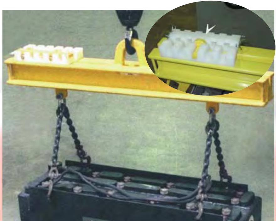
Position correcte du crochet pour la taille de la batterie et angle de crochet correct.
