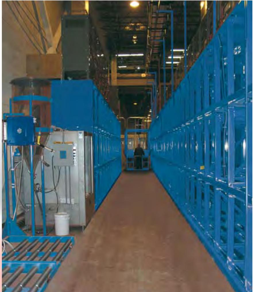
**Chariot de transfert BBH- un niveau avec stockage de batteries sur 2 côtés. Le système inclut une laveuse de batterie automatique, et un système de gestion des batteries par ordinateur pour fournir « la meilleure batterie » et programmer le remplissage et le lavage des batteries.**
